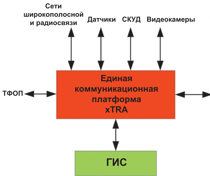
Рис. 1. Концептуальная схема типового рабочего места оперативного дежурного на базе единой коммуникационной платформы xTRA
